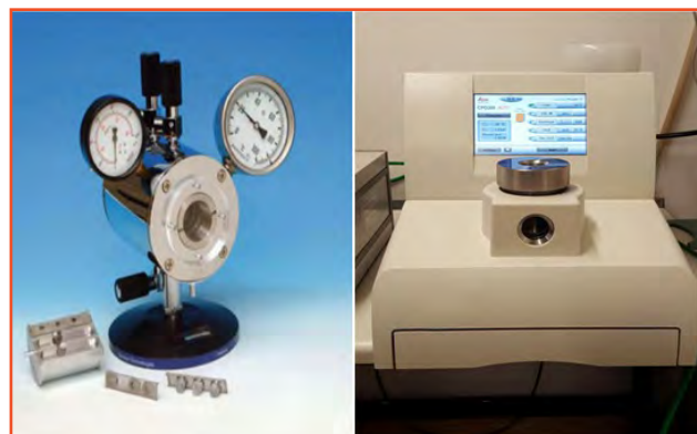
شکل (۴): دو نمونه متفاوت از خشک کن نقطه بحرانی (CPD) با ظاهری متفاوت ولی عملکردی یکسان [۱].
